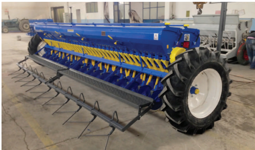
4-сүрөт. СЗТ-3,6 дан чөп себүүчү агрегат
