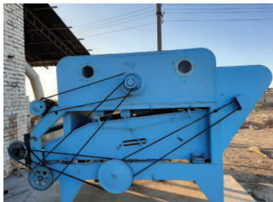
12-сүрөт. Үрөндү тазалоочу жана сорттоочу машиналар
