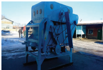
12-сүрөт. Үрөндү тазалоочу жана сорттоочу машиналар
